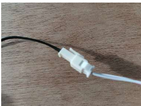
(3) Podłącz złącze czujnika temperatury
